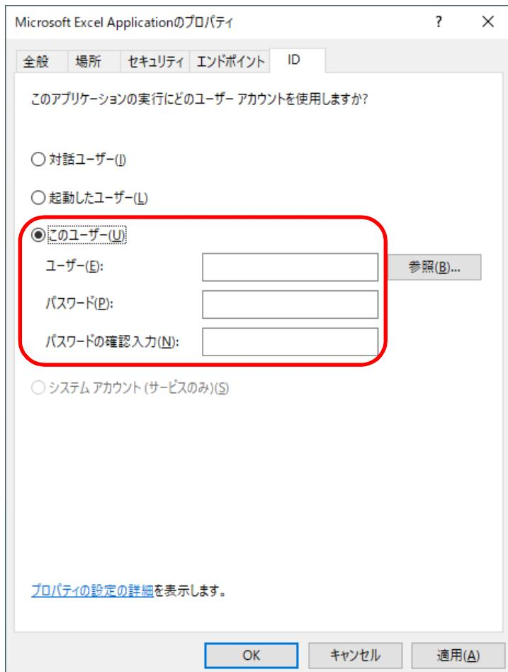
上記設定をすることにより、サーバで Excel を起動する際には、必ず設定したユーザとして起動されるようになります。同じサーバにて PDF オートコンバータ EX 以外のアプリやシステムで Excel を操作するマクロ等を動かす場合には、問題が起きる可能性があります。基本的には別サーバで処理してください。
