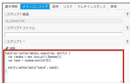
図：スクリプトタスク「ユーザAのじゃんけんの手を決める」の「プロパティエリア」-「メインコンフィグ」-「スクリプト」
