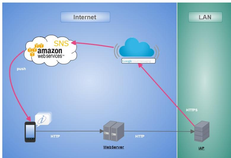
図 FCM+Amazon SNS を使用する際のサーバ構成例
