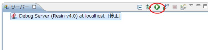
「サーバ」ビューで、「サーバを停止」ボタンを押下すると、デバッグサーバが停止します。
