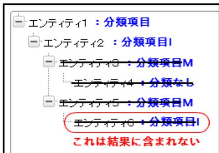
図に示すエンティティ6は分類項目Iを持っていますが、内包構造上、親であるエンティティ5が分類項目Iを持たないため、ツリーに表示されません。
